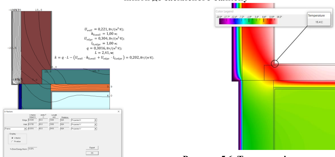
Рисунок 5.6. Теплопровідне включення примикання зовнішніх стін Тип 2 до перекриття неопалювального підвалу
