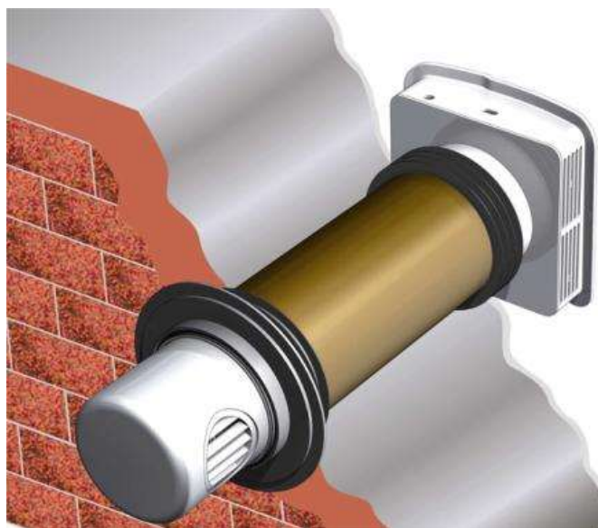
Рисунок 8. Схематичне зображення внутрішньостінного рекуператора
