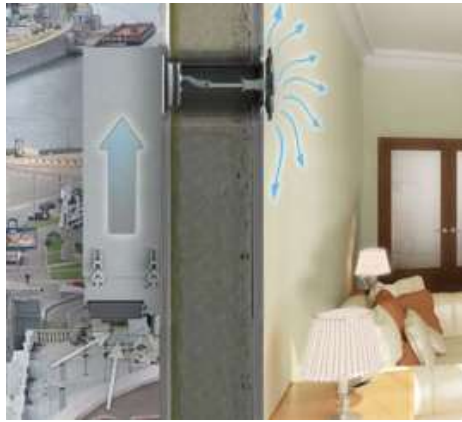
Рисунок 9. Монтаж рекуператора на фасадній стіні. Загальний вигляд
